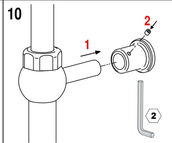
**SOSTITUZIONE VITONE / VALVE REPLACEMENT**
